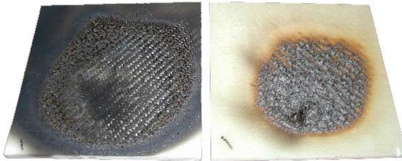
Stratifiés époxy / Verre E après test au feu: Epoxy bromé / Epoxy SR 1126
