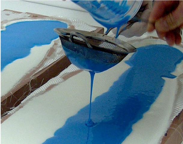
Lors du mélange de la résine **PB x70 i** et du durcisseur, de l'air est inclus. Une mousse expansée sans macro bulles est obtenue en filtrant le mélange sur un tamis ayant une maille de 1 à 2 mm.
