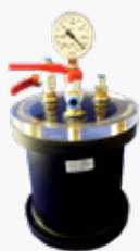
Piège sous vide 5 L Il est conçu pour protéger la pompe et dégazer la résine. Diamètre intérieur : 170 mm Hauteur : 190mm à l'unité
